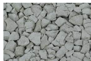
転圧後 (1 t 振動ローラー 4 回後)
