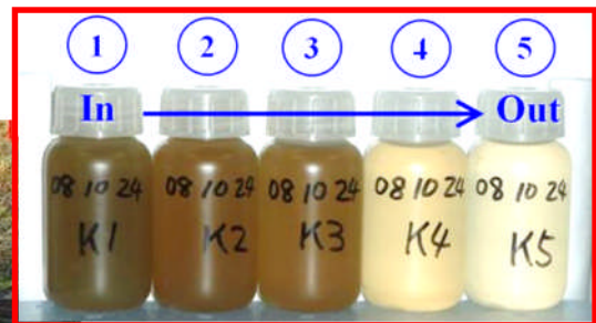
▲排水処理水のサンプル 排水は、①から⑤の方向へ複数段の濾床を流れ浄化されています。
