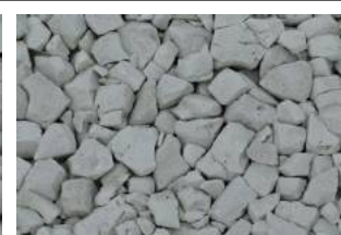
転圧後 (1 t 振動ローラー 4 回後)
